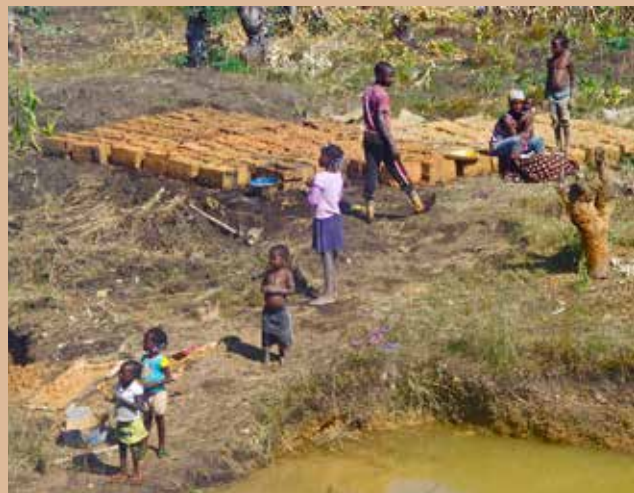
A produção do adobe decorre durante a época seca. Os adobes são constituídos por uma mistura de terra, capim e água, e secam ao sol.
